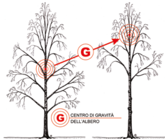
IMMAGINE 16: L'aumento del carico meccanico su un albero derivante dall'innalzamento del baricentro di chioma può accrescere i rischi di cedimento della pianta nel suo insieme.
