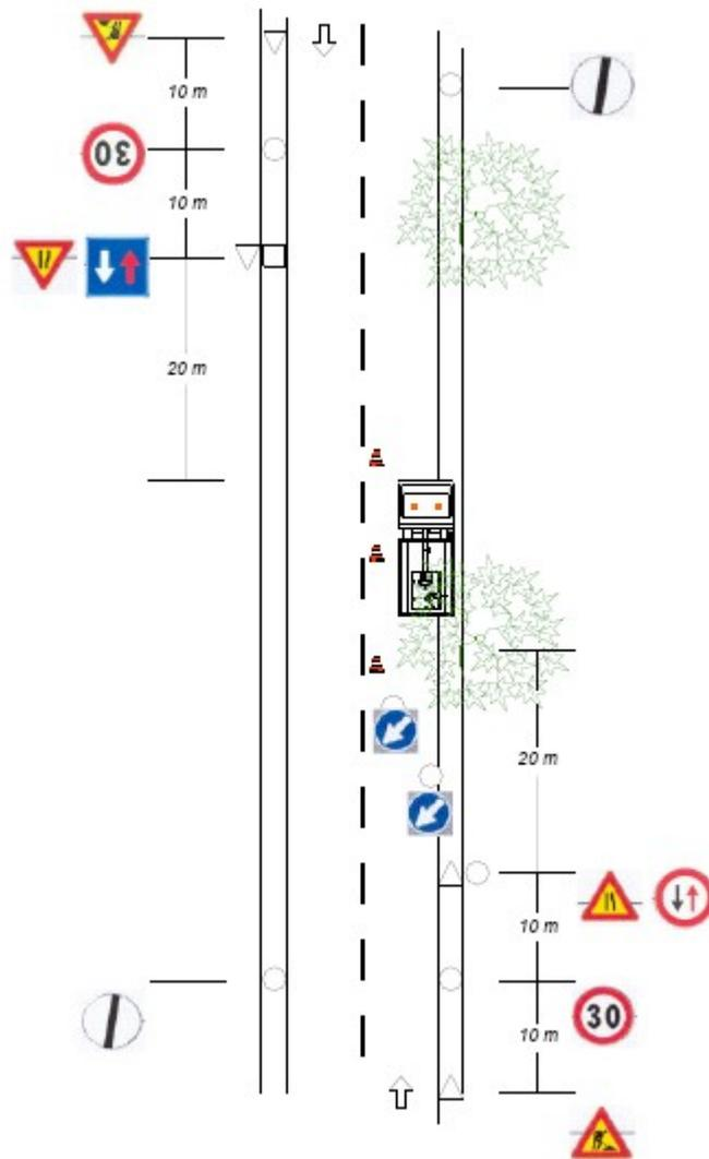
INSTALLAZIONE DI CANTIERE TEMPORANEO – CANTIERE URBANO A MARGINE DELLA CARREGGIATA A DOPPIO SENSO DI MARCIA CON MOVIERI E CON CARREGGIATA RESIDUA < 5,6 METRI
