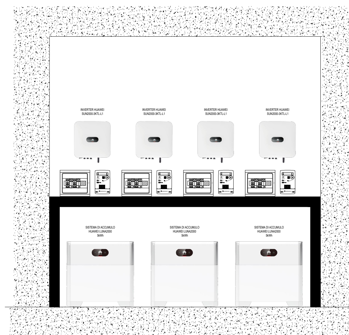
PARTICOLARE INGOMBRO DI MASSIMA VANO CONTATORI CONDOMINIALI
