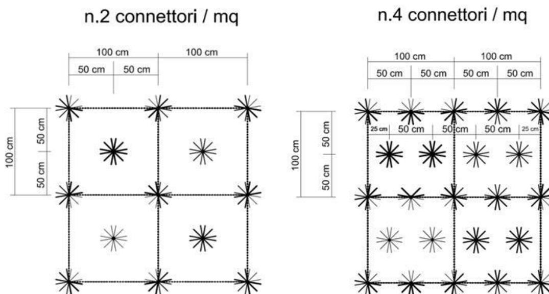
Nel caso risulti necessario trasferire le azioni di trazione del sistema di rinforzo anche attraverso un maschio murario ovvero in un cantonale, per realizzare una fascia di piano si dovrà valutare attentamente il dettaglio costruttivo, al fine di garantire la continuità o l'ancoraggio in modo adeguato, anche utilizzando tipologie di sfioccamento o di sovrapposizione. Tali indicazioni dovranno trovare riscontro nei manuali di installazione
