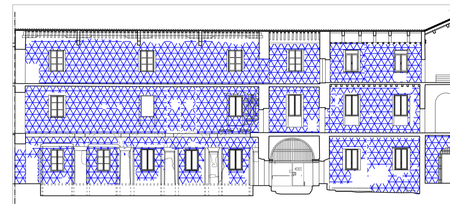
INDIVIDUAZIONE DEI DEGRADI ESTESI scala 1:200
