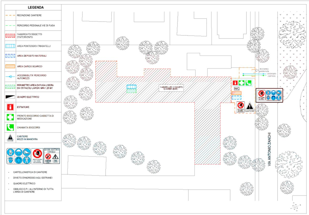
Figura 2 – Layout di cantiere –
