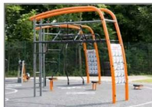
Per garantire l'integrità del telaio principale, i montanti principali di colore arancione sono realizzati con montanti in acciaio 101,6 x 3 mm, zincati a caldo e verniciati a polvere arancione (RAL2010). I pali di sostegno ricevono lo stesso trattamento superficiale e sono realizzati in tubi di acciaio 76,1 x 3,6 mm, verniciati a polvere in grigio (RAL7012).
