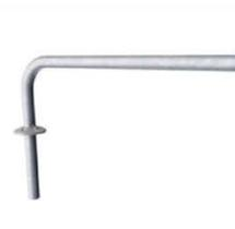
I corrimani intesi come impugnature durante gli esercizi sono realizzati in acciaio zincato a caldo da 38 mm, un grande diametro per una buona presa e per sostenere il polso. L'altezza del corrimano è 940 mm dalla parte superiore della piastra HPL. La distanza tra le rotaie è di 900 mm.
