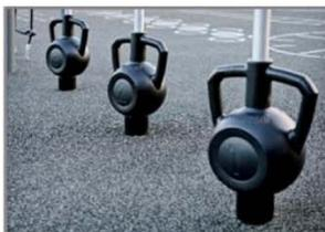
I tubi su cui si muovono le Magnetic Bells sono 40 mm, realizzati in alluminio di grado AW 6082-T6 e hanno uno strato anodizzato di 20 µm. Il tubo ha un nucleo in acciaio pieno per l'integrità strutturale.
