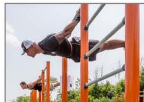
La barra di sollevamento è montata ad un'altezza di 233 cm con uno spazio per il workout sottostante, accanto a una scala verticale con 6 barre orizzontali. Gli spazi tra barre sono di 38 cm.
