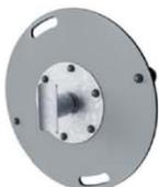
La sede del cuscinetto è in acciaio zincato a caldo. L'albero del cuscinetto è realizzato in acciaio inossidabile AISI304. Il cuscinetto stesso è realizzato in poliossimetilene (POM), un tecnopolimero termoplastico con elevata rigidità, basso attrito ed eccellente stabilità dimensionale.
