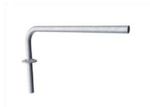
I corrimani intesi come impugnature durante gli esercizi sono realizzati in acciaio zincato a caldo da 38 mm, un grande diametro per una buona presa e per sostenere il polso. L'altezza del corrimano è 940 mm dalla parte superiore della piastra HPL. La distanza tra le rotaie è di 900 mm.
