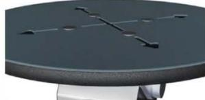
La piastra superiore da 414 mm è realizzata in Ekogrip da 15 mm, una piastra polietilene (PE) da 15 mm con uno strato superiore in gomma termoplastica da 3 mm con effetto anticivolo. L'altezza è di 217 mm e la gamma di movimento è di +/- 90, con uno strato in gomma EPDM su ciascuna estremità.
