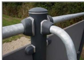
I connettori sono realizzati in alluminio pressofuso, appositamente legati per gli ambienti esterni e l'uso intenso. Le viti che fissano i connettori sono in acciaio inossidabile protette da rondelle di zinco.
