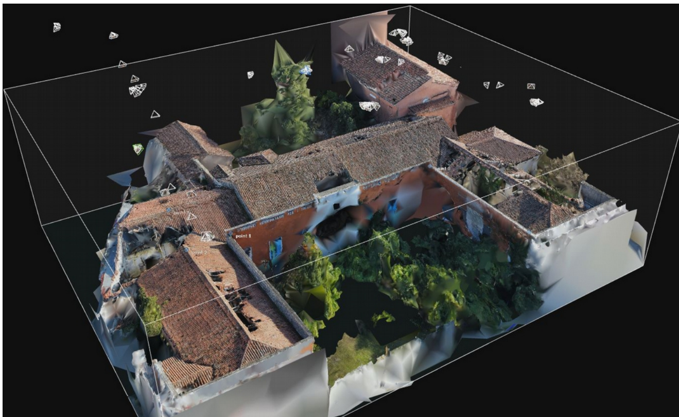
23 RESTITUZIONE DELLA NUVOLA DI PUNTI COMBINATA CON LE FOTOGRAFIE AEREE DAL DRONE
