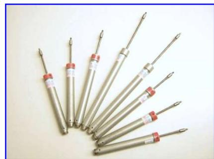
Il sistema di acquisizione dati consente di diagrammare in tempo reale l'andamento delle deformazioni nelle diverse fasi di carico/scarico. Questo è importante per evitare di scambiare per deformazioni da rilascio tensionale, episodi che invece sono originati da locali distacchi e/o disarticolazione degli elementi murari.
