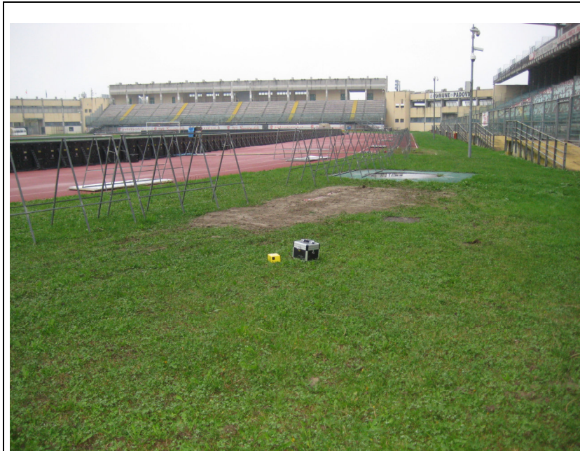
Foto 7: Esecuzione indagine sismica HVSR
