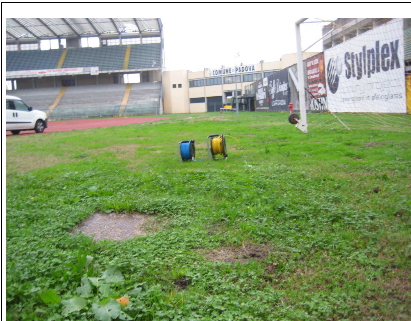
Foto 6: Esecuzione indagine sismica MASW
