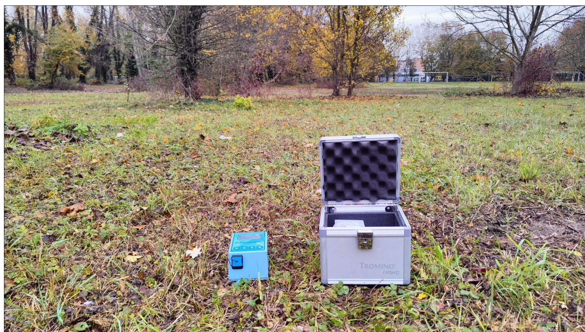
Tromografo su punto di acquisizione
