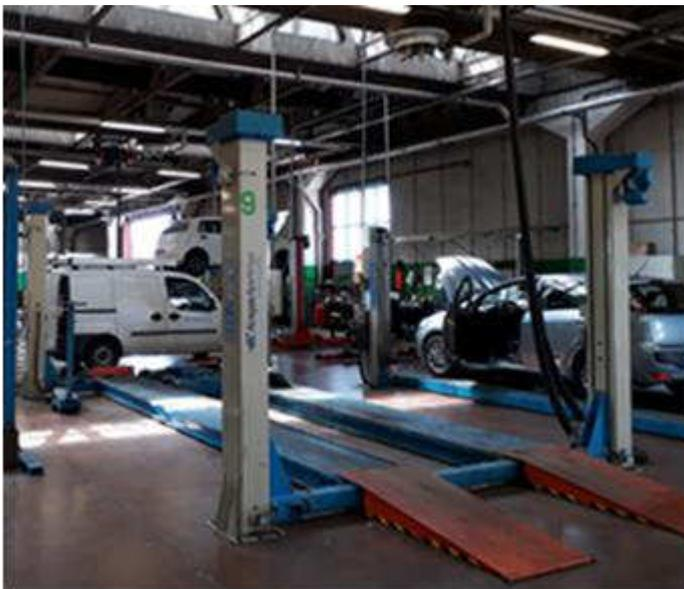
Figura 7. Ponte sollevatoio a 6 assi.
