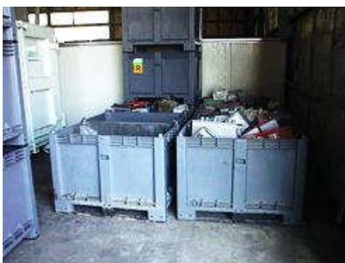
**Figura 10. Contenitori riempiti di batterie al piombo.**
