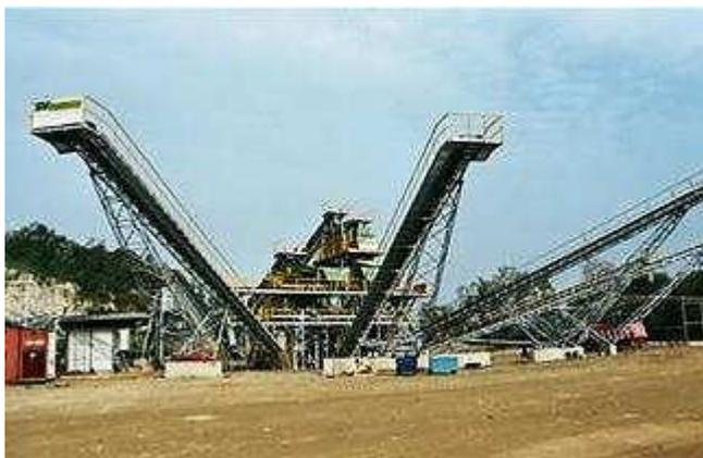
**Figura 12. Impianto per recupero inerti.**
