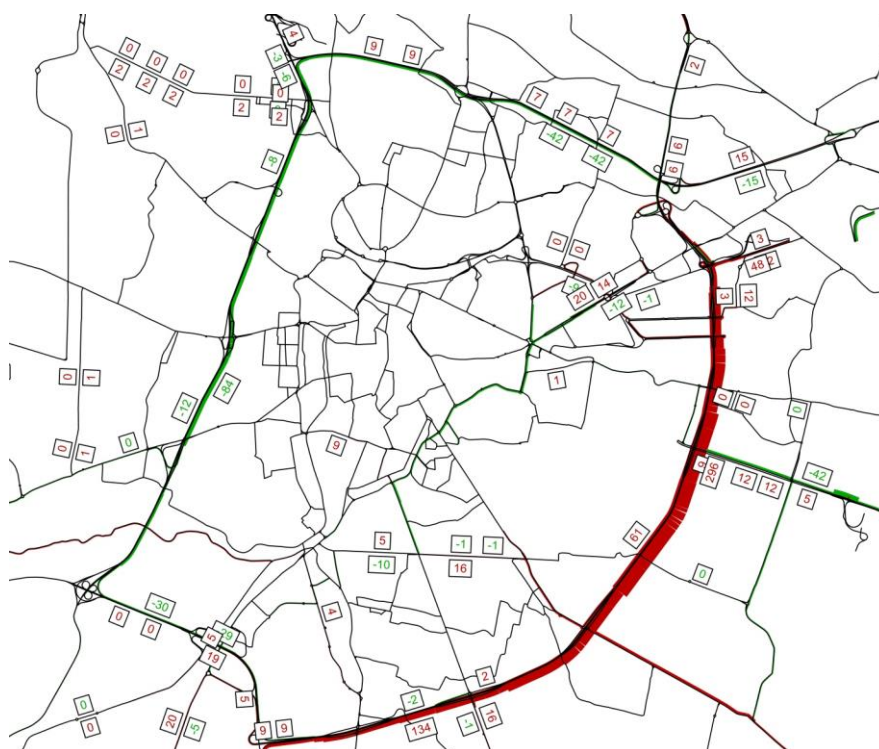
Fig. 7.7: Variazione dei flussi di traffico a seguito dell'incremento della capacità della tangenziale est di Padova
