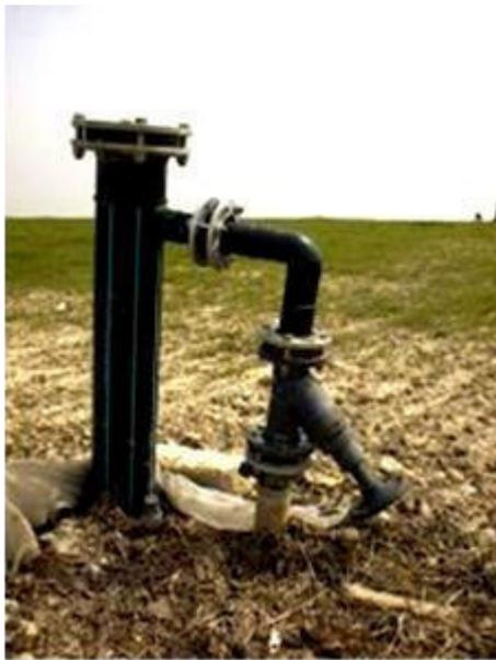
**Figura 25.** Particolare dell'impianto di captazione biogas: pozzetto di raccolta.
