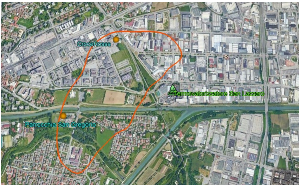
Figura 1. Posizione dei punti di monitoraggio 2019, del camino del termovalorizzatore e dell'isolinea ricavata dalla simulazione modellistica
