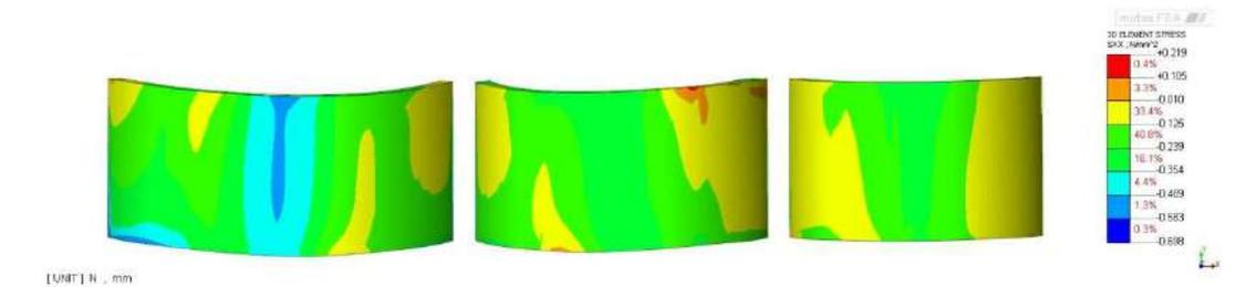
Figura 8.76 Vista 3 - Tensioni di trazione e di compressione in direzione tangenziale all'arco [N/mm²] - Massima a trazione 0.219N/mm² - Massima a compressione -0.698N/mm²
