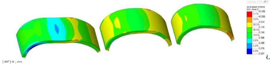
Figura 8.11 Vista 1 - Tensioni di trazione e di compressione in direzione tangenziale all'arco [N/mm<sup>2</sup>] – Massima a trazione 0.196N/mm<sup>2</sup> – Massima a compressione -0.687 N/mm<sup>2</sup>
