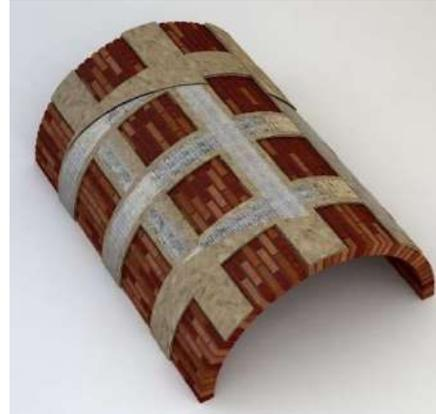
*Rinforzo mediante fasce in fibra di acciaio*
