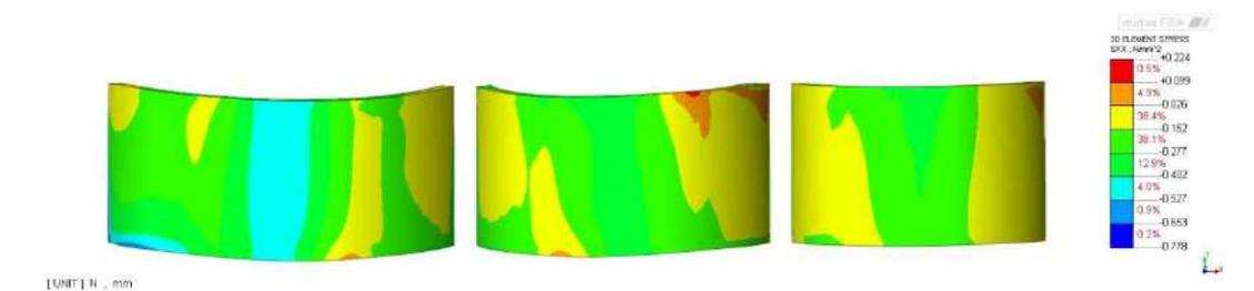
Figura 8.55 Vista 3 - Tensioni di trazione e di compressione in direzione tangenziale all'arco [N/mm<sup>2</sup>] – Massima a trazione 0.224N/mm<sup>2</sup> – Massima a compressione -0.778N/mm<sup>2</sup>
