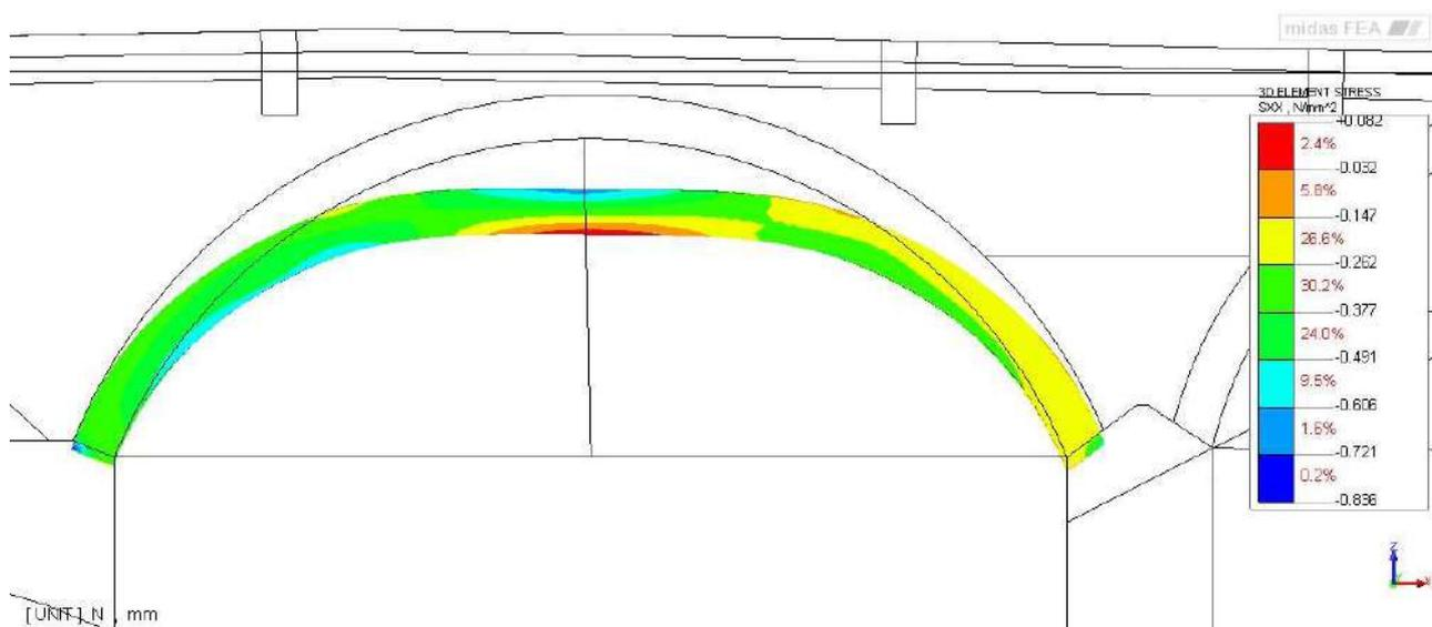
Figura 7.59 Vista 3 - Tensioni di trazione e di compressione in direzione tangenziale all'arco [N/mm<sup>2</sup>] – Massima a trazione 0.082 N/mm<sup>2</sup> – Massima a compressione -0.836 N/mm<sup>2</sup>
