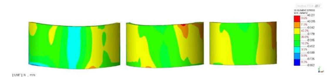
Figura 8.83 Vista 3 - Tensioni di trazione e di compressione in direzione tangenziale all'arco [N/mm<sup>2</sup>] - Massima a trazione 0.231N/mm<sup>2</sup> - Massima a compressione -0.862N/mm<sup>2</sup>
