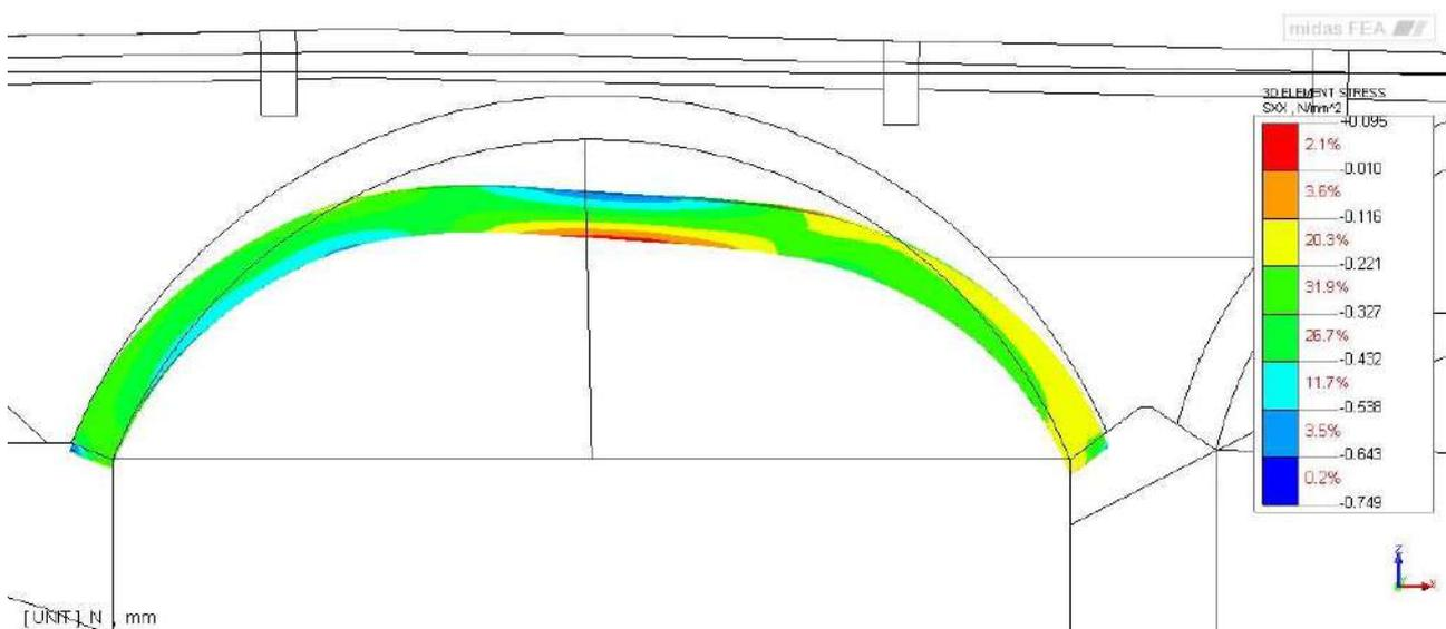
Figura 7.68 Vista 3 - Tensioni di trazione e di compressione in direzione tangenziale all'arco [N/mm<sup>2</sup>] – Massima a trazione 0.095 N/mm<sup>2</sup> – Massima a compressione -0.749 N/mm<sup>2</sup>
